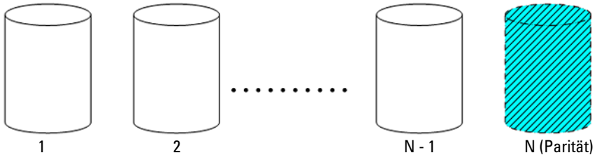
Abbildung 2-1. Logische Ansicht der Datenträgernutzung in einer RAID-5-Gruppe von N physischen Laufwerken
